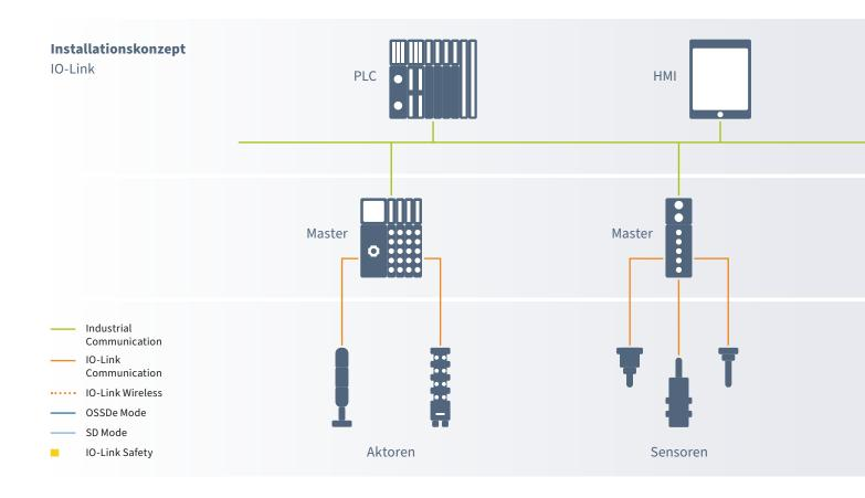
die Feldebene gebracht. So konnten Daten mit höchster Präzision direkt an der Quelle erfasst, transportiert und verarbeitet werden. Der Grundstein für eine effizientere und zuverlässigere Automatisierung war gelegt. IO-Link 1.0 machte aber nicht nur eine feldbusunabhängige Kommunikation
